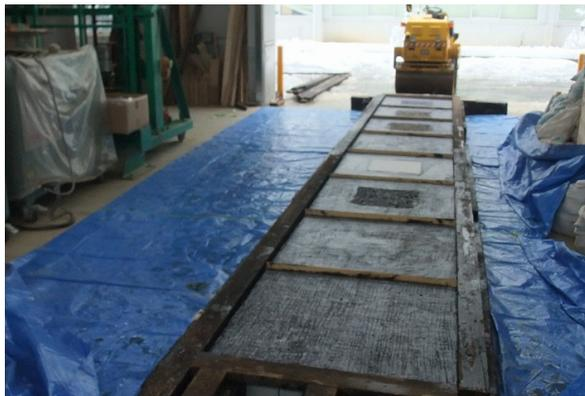
写真4 アスファルト混合物舗設状況
